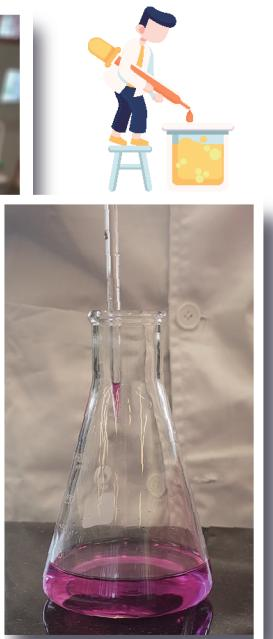
① 首先，要用去離子水清洗實驗所用到的儀器，因為要確保實驗不會受到其它雜質污染。我們先用移液管同膠泵將 $5\text{cm}^3$ 的水樣本加入到錐形瓶。
